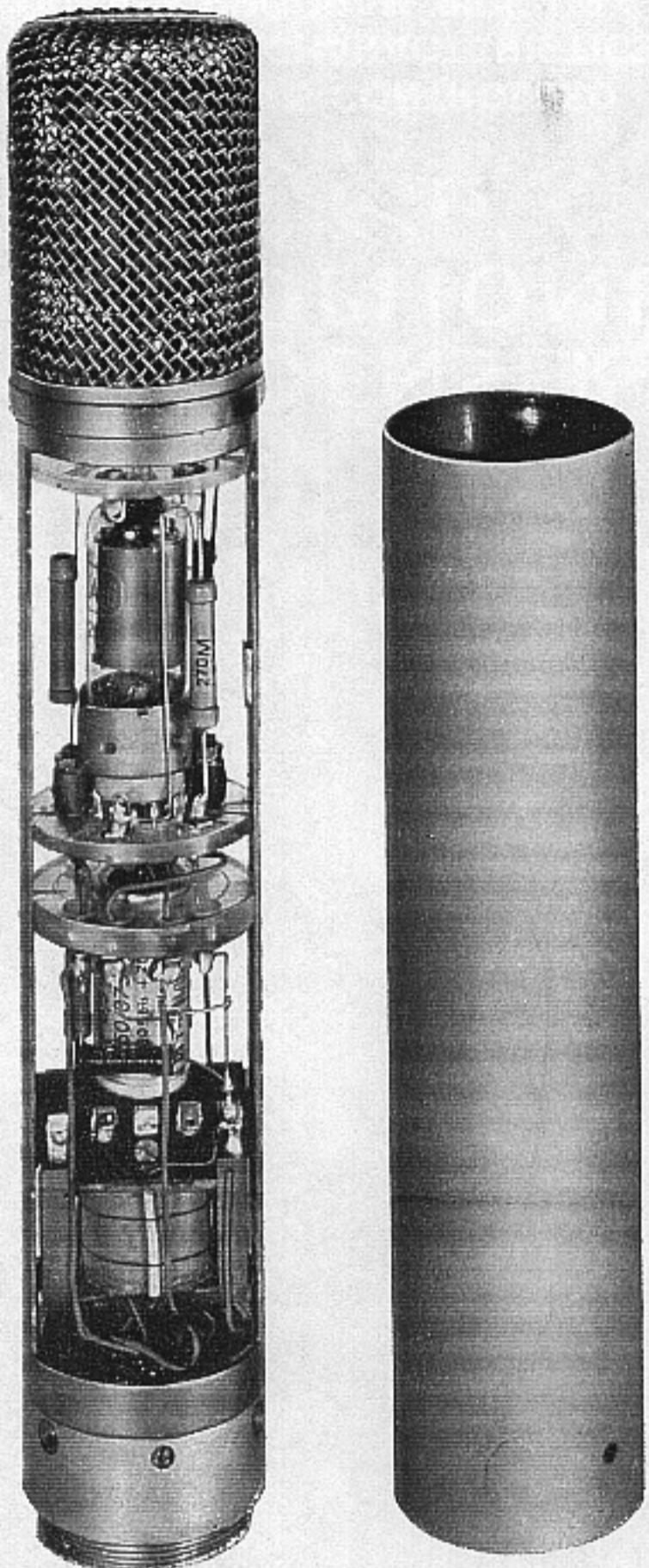
Das Mikrofon C 12, in Gestalt eines schlanken Zylinders von 42 mm Ø, enthält die Kondensatormikrofonkapsel, eine Röhre 12AY7 und den Ausgangstransformator. Es ist durch ein mehrpoliges Kabel von 20 m Länge (auf Wunsch Längen bis zu 200 m) mit dem Netzanschlußgerät verbunden. Ein zweites mehrpoliges Kabel führt vom Netzanschlußgerät zum Richtcharakteristikregler. Dieser ermöglicht die Einstellung auf Kugel-, Nieren- und Achtercharakteristik (sowie 6 Zwischenstellungen) während der Aufnahme.
