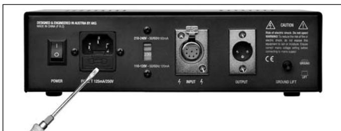
Fig. 20 : Ouverture du compartiment des fusibles
